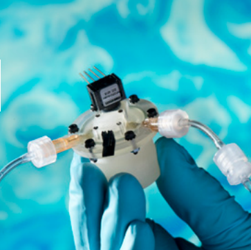
Der Entgaser verfügt über eine integrierte Silizium-Mikropumpe, die den nötigen Unterdruck erzeugt. © Fraunhofer EMFT / Bernd Müller
